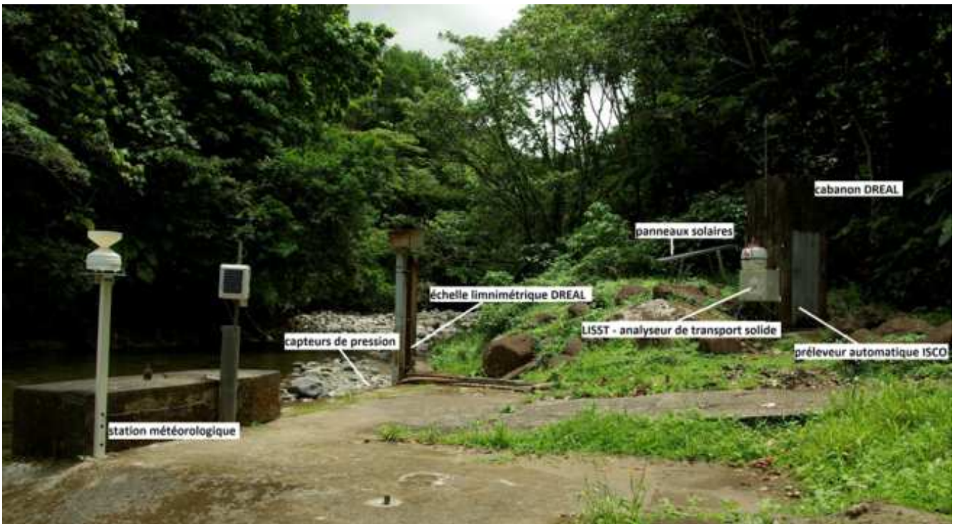
Fig. 3a : Site instrumenté de la rivière de Capesterre à proximité de la station hydrologique de la DEAL.
